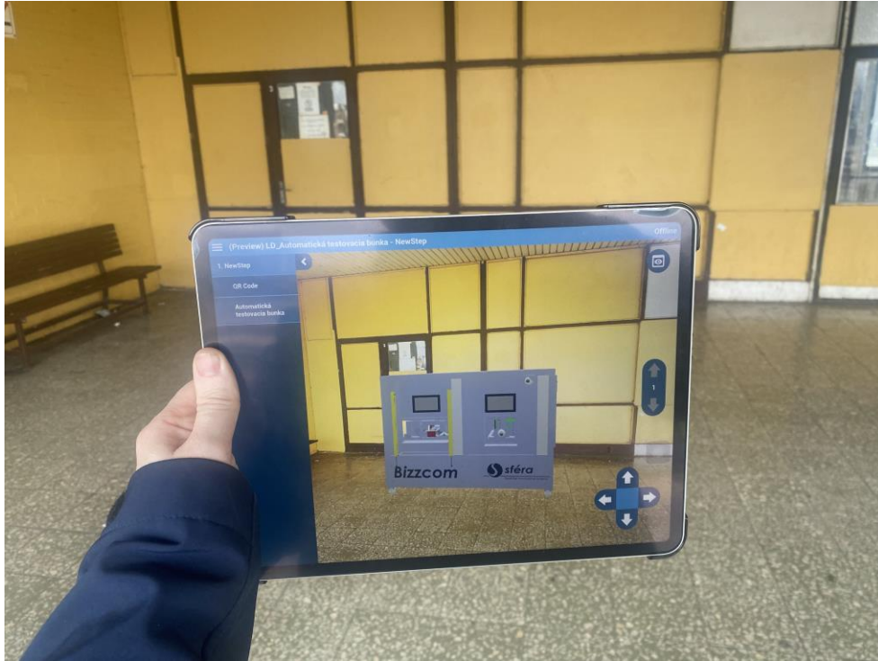
Obrázok 132: Automatická testovacia bunka - testovanie umiestnenia v priestore pomocou AR - model bol umiestnený na vlakovej stanici (vonkajší priestor, čiastočne prekrytý, pohľad spredu)
