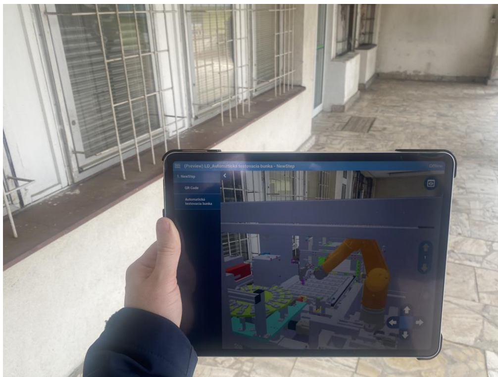
Obrázok 130: Automatická testovacia bunka - testovanie umiestnenia v priestore pomocou AR - model bol umiestnený v zdravotníckom zariadení (vonkajší priestor, čiastočne prekrytý, pohľad z boku na robota)
