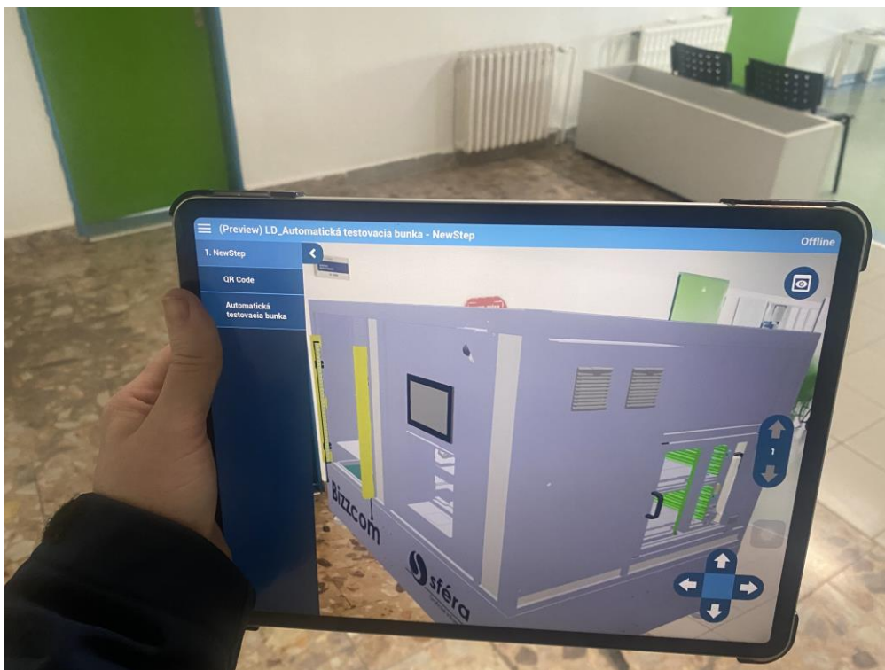
Obrázok 126: Automatická testovacia bunka - testovanie umiestnenia v priestore pomocou AR - model bol umiestnený v zdravotníckom zariadení (vnútorný priestor, pohľad z boku)
