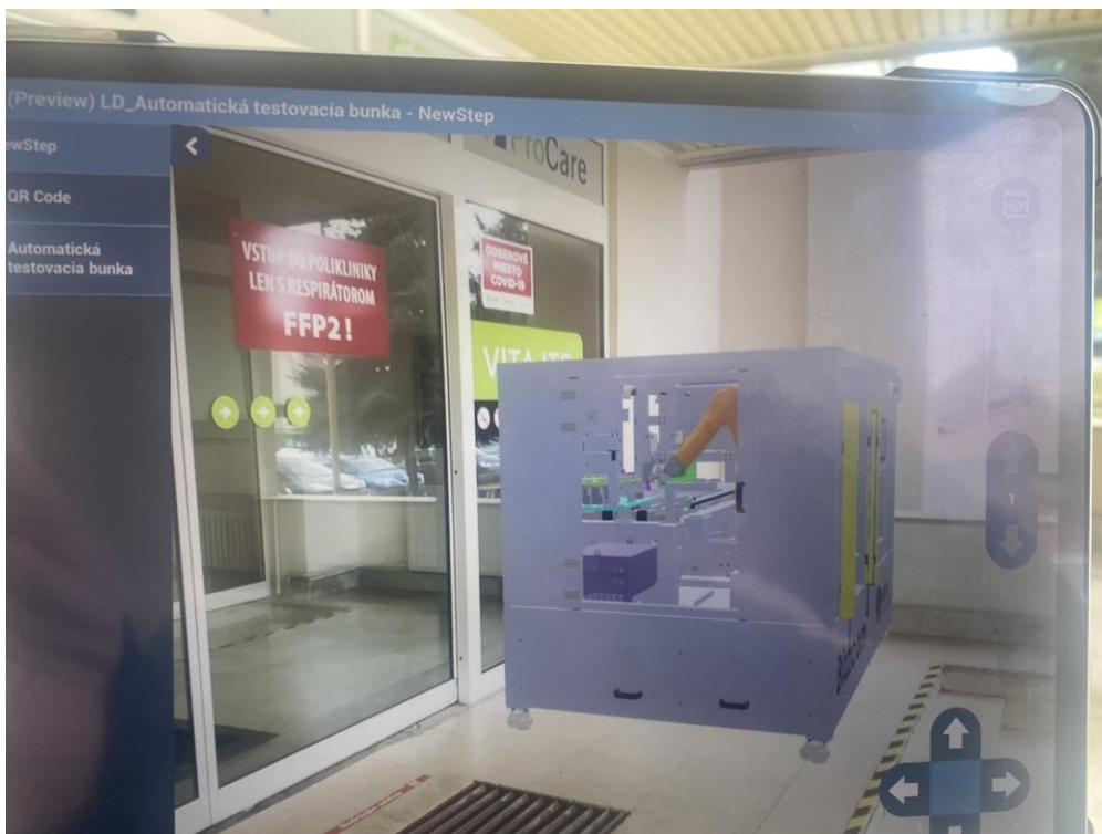
Obrázok 113: Automatická testovacia bunka - testovanie umiestnenia v priestore pomocou AR - model bol umiestnený pri vstupe do polikliniky (pohľad z boku)
