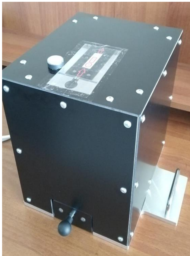
Obrázok 99: Reálne vyhotovenie mobilného zariadenia(Momka) na manuálne snímanie testov - (pohľad spredu, po pridaní nepriesvitného krytovania z dôvodu ochrany kamery pred svetlom)
