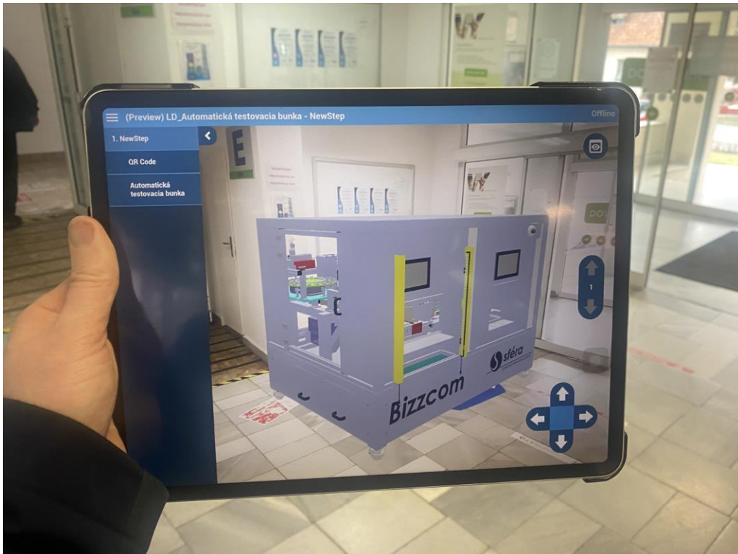
Obrázok 116: Automatická testovacia bunka - testovanie umiestnenia v priestore pomocou AR - model bol umiestnený pri vstupe do polikliniky (vnútorný priestor vstupná hala, pohľad spredu)
