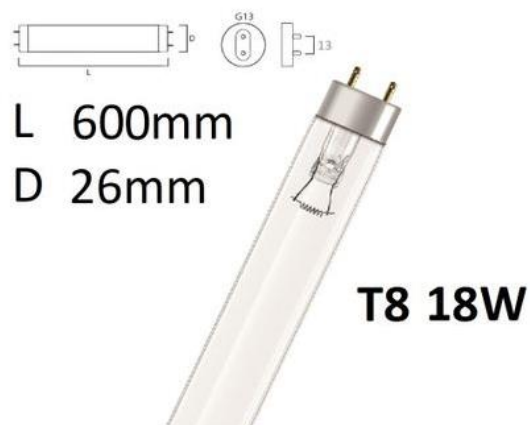
Obrázok 18: Žiarivka 18W/UV-C T8 G13, germicídna, 26 × 600 mm
