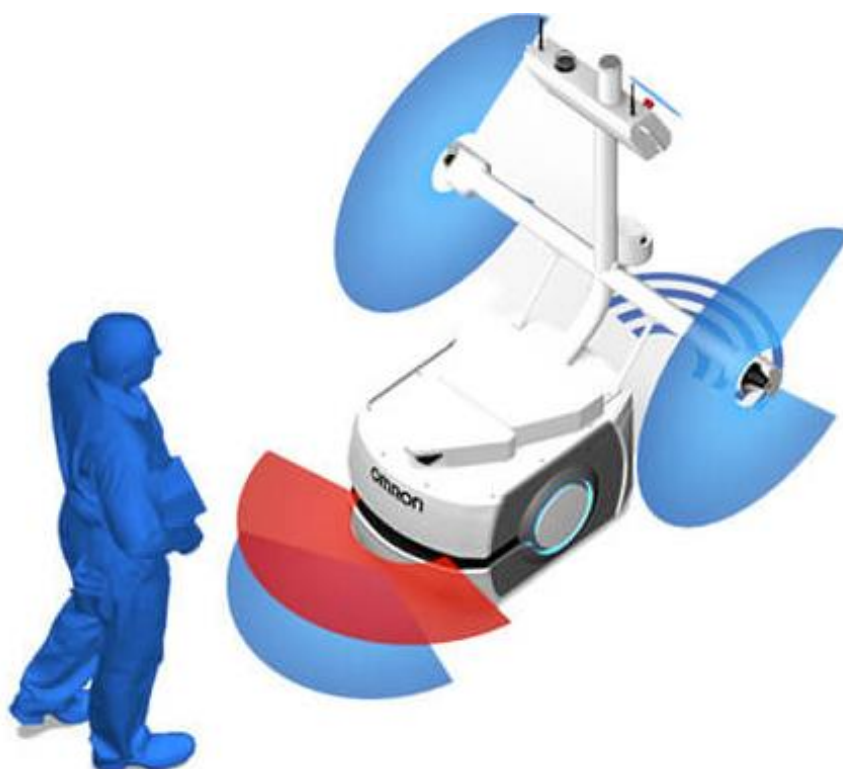
Obrázok 31: Protikolízne snímače od firmy OMRON – ukážka možnej rozšíriteľnosti snímačov
